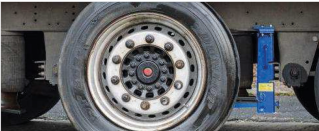
Der Greifus-Achsheber (blau) wird am Fahrzeugrahmen befestigt und sorgt dafür, dass sich das kaputte Rad hebt. | Foto: GTM Fahrzeugbaumodule
