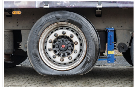
Bei Greifus handelt es sich um einen „variablen, einseitig einsetzbaren Rad-, Reifen- und Achsheber für alle gängigen Sattelaufleger“
